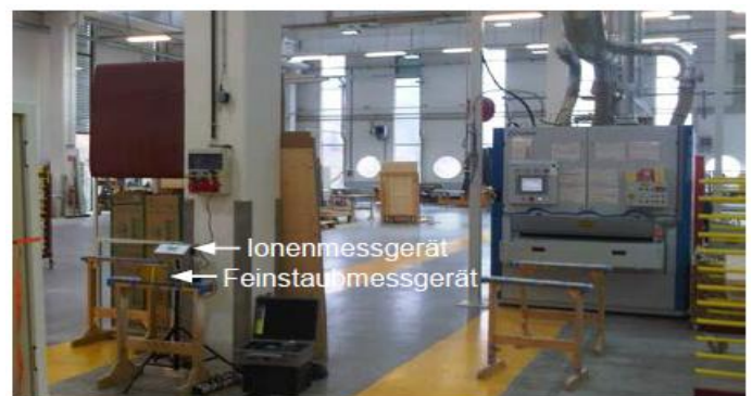
Figure 1 : Vue de la halle de production, à gauche devant la colonne, l'emplacement de l'appareil de mesure d'ions et de poussière fines.
